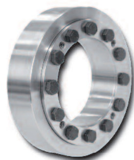
缩紧盘 通过外部缩紧连接消除空心轴或 轮毂与实心轴之间的反向间隙
