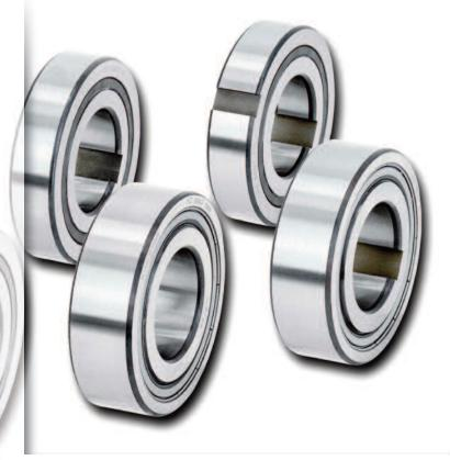
Um den Ingenieuren der Antriebstechnik möglichst viel Spielraum zu lassen, bietet RINGSPANN die neuen Freiläufe in fünf Grundausführungen mit jeweils acht bzw. neun Größen für die Übertragung von Nenndrehmomenten von bis zu 420 Nm (am Außen- oder Innenring) an. Für den Einsatz unter anspruchsvollen Bedingungen (Schmutz, Nässe etc.) sind zwei Grundausführungen zusätzlich mit 2RS-Abdichtungen ausgestattet.
