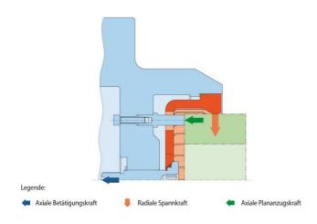
Der Korbkörper sitzt mit Vorspannung im Stützdurchmesser der Aufnahme. Zum Spannen wird der Korbkörper mittels einer axialen Betätigungskraft elastisch verformt, dabei wird das Werkstück zentriert, an die Anlage gedrückt und plan ausgerichtet.
